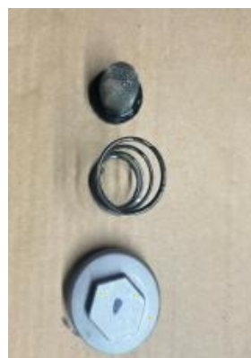
Capacul șurubului filtrului de ulei Cuplu de strângere: 10 N-m
