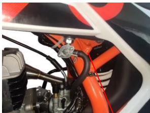
Comutator rezervor de combustibil
