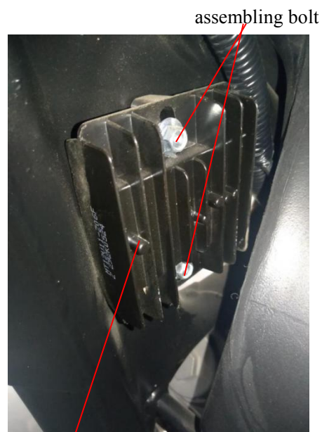
steady voltage rectifier
