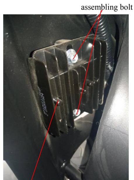
steady voltage rectifier
